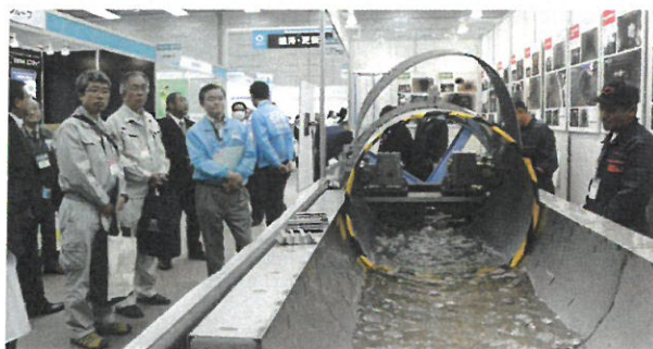
元押し製管機によるデモ施工の様子
