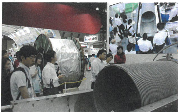
新型の元押し型製管機によるデモ施工
