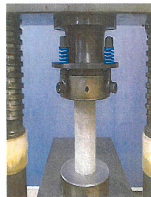
写真-4 圧縮強度試験状況
