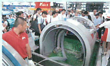
■ 自由断面SPR工法製管実演
