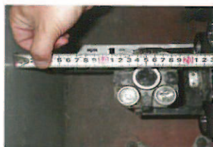
写真-1 壁からレンズまでの距離を測定
